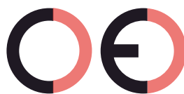
Faux marquage CE (trop éloigné)
