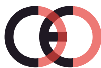
Faux marquage CE (trop proche)
